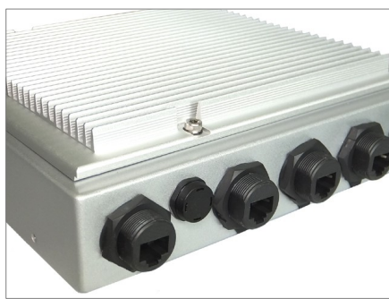
エクステンション・コネクタを使用すれば一般的なLANケーブルが使えます
