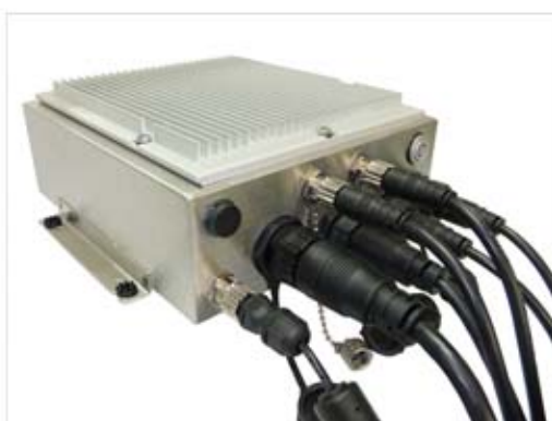
各ケーブルを取り付けたところ
